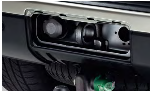
13PIN Towing Electrics VPLAT0136
